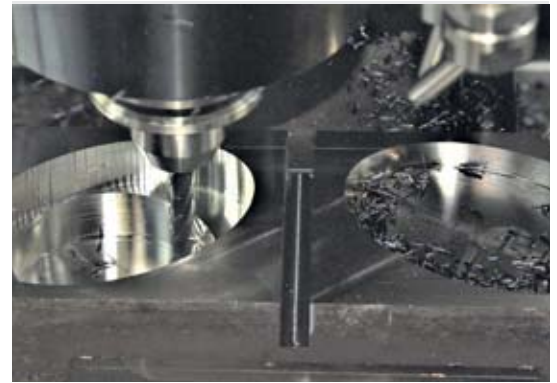
Testbearbeitung-Maschinen-Check. Nutenfräsen: Tiefe: 2xD; Ø=10mm Kavität fräsen im Vergleich: Normalablauf, rechts imachining, links, a p = 40 mm (2x20) a e = 0,6mm, vc = 250m/min
