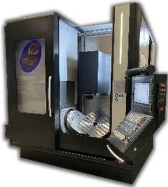
Das neue, mit einem Dreh-/Schwenktisch ausgestattete 5-Achs-Vertikal-BAZ Raffaello R5A.6 von REMA CONTROL wird auf der EMO mit einem ergänzenden Palettenwechselsystem zu sehen sein. Bild: teamtec
